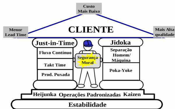
Figura 3 - Estrutura do STP
